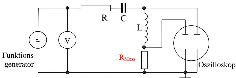
Hinweis: Als Messwiderstand ( $R_{\text{Mess}}$ ) zur Strommessung werden  $10 \text{ }\Omega$  eingesetzt.
