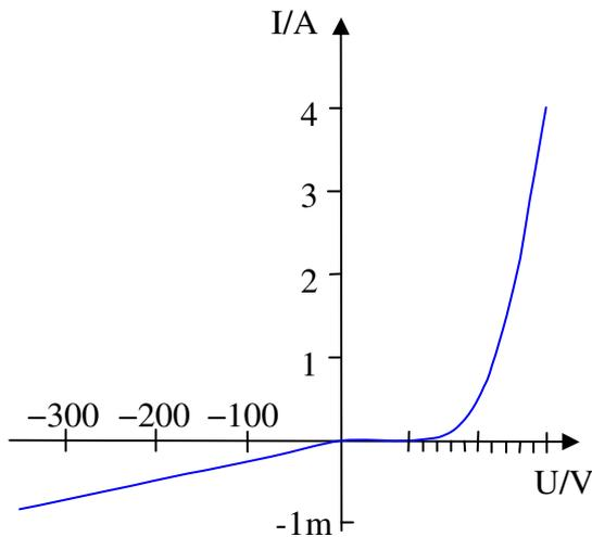
Bei einer Einweggleichrichtung wird für die Diode folgender Strom gemessen:
