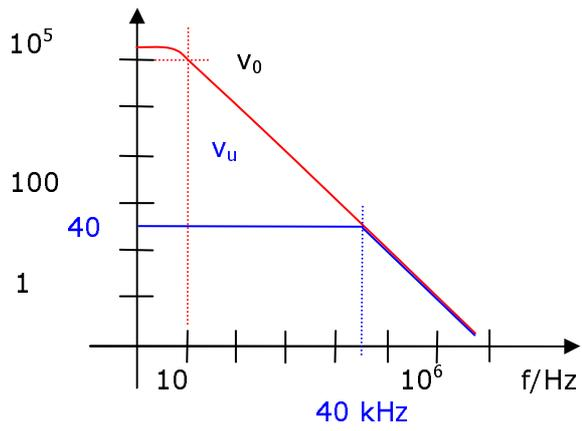
Zur Drift von 90 dB kommt der Faktor  $v_0/v_u = 5000$  entspricht 74 dB dazu also 164 dB.
