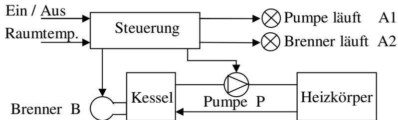
Ablaufsteuerung für die Heizungsanlage:
