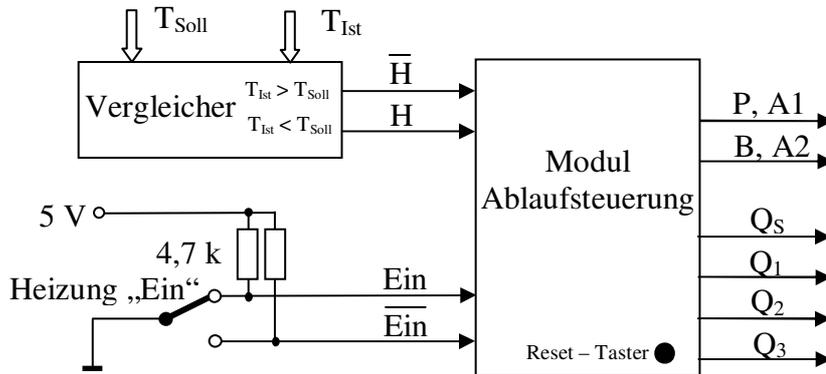
Verbinden Sie auf einem Testbrett Vergleicher, Einschalter und Modul entsprechend dieser Schaltung.
