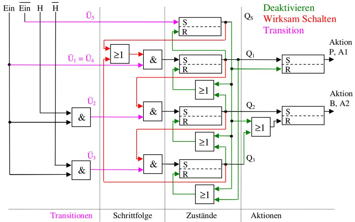
Schaltung der Ablaufsteuerung mit Modul und Vergleicher zur Simulation der Heizung:
