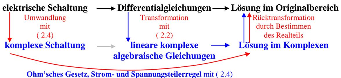
**Abb. 2.2: Schema zur Lösung mittels komplexer Rechnung**
