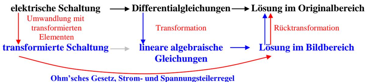
**Abb. 1.1: Schema zur Lösung mittels Transformation**
