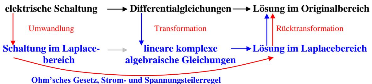
Abb. 3.5: Schema zur Lösung mittels Laplacetransformation
