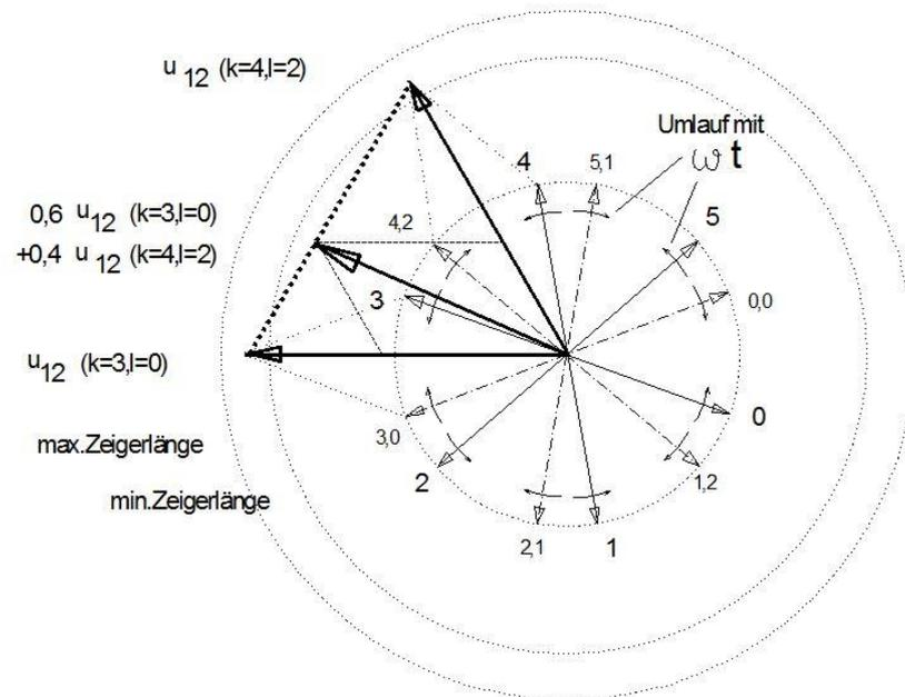
Bild 2: Beispiel zur Kalkulation eines Sollvektors
